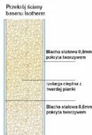
Przekrój ściany basenu
